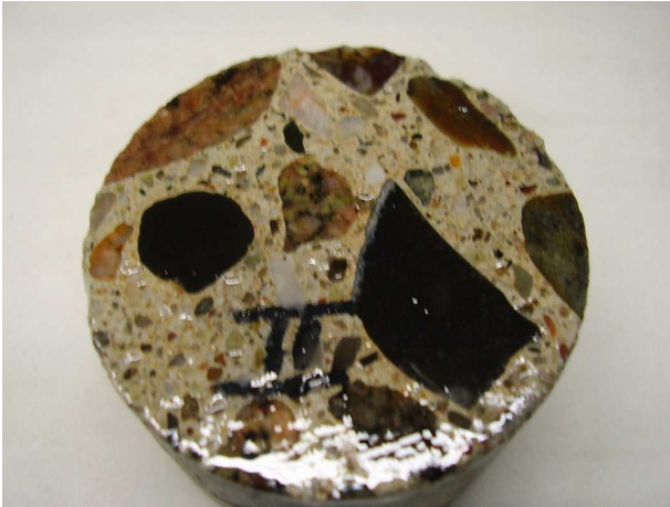
Abbildung 4: beschichtete Probenoberfläche mit reaktiven Gesteinskörnungen 3
