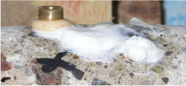
Abbildung 1: Gelausscheidungen nach 15 Tage Lagerung im Nebelkammerklima
